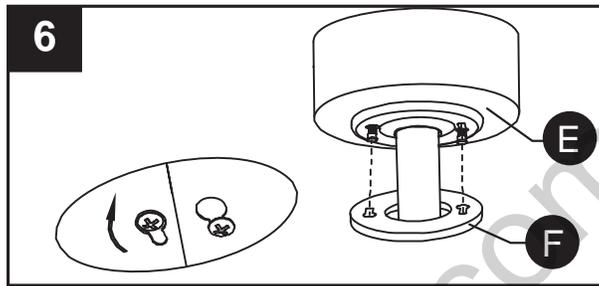
6. Desserrez les deux vis à épaulement sans retirer complètement de la fixation suspendue (A). Assemblez le couvercle (E) en tournant la fente du trou de serrure du couvercle sur les vis à épaulement dans la fixation suspendue (A). Resserrez les vis à épaulement. Attachez bien et serrez la fermeture du trou du couvercle (F) sur les vis à épaulement dans la fixation suspendue (A) en utilisant la fonction de verrou rotatif de fente du trou de serrure.
