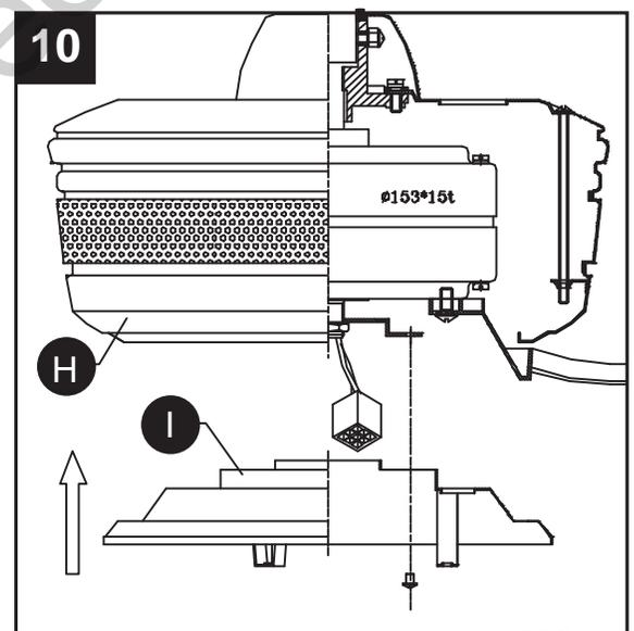
11. Installer le boîtier d'abat-jour : relevez l'assemblage du boîtier de pale (I). Aligned les étiquettes à points rouges sur la plaque de montage et le boîtier de pale (I). Fixez le boîtier de pale (I) à l'assemblage du moteur (H) avec les vis fournies.
