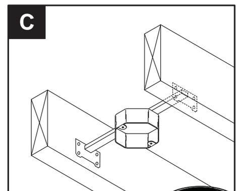
1. Fixez la fixation suspendue (A) au coffret de courant du plafond utilisant les vis et les rondelles fournies avec le coffret de courant. Important : si vous installez le ventilateur à un plafond en pente, assurez-vous que l'extrémité ouverte de la fixation de montage soit installée face au toit. N'installez pas le ventilateur sur un plafond avec une inclinaison de plus de 20°.
