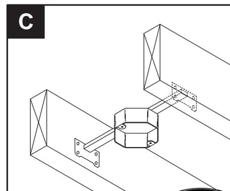
1. Fixez la fixation suspendue (A) au coffret de courant du plafond utilisant les vis (C) et les rondelles (B) fournies avec le coffret de courant. Important : si vous installez le ventilateur à un plafond en pente, assurez-vous que l'extrémité ouverte de la fixation de montage soit installée face au toit. N'installez pas le ventilateur sur un plafond avec une inclinaison de plus de 20°.
